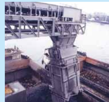
焼却灰積み出し設備…焼却後の灰および処理されたばいじんは、ここで船に積み処分地へ運びます。
