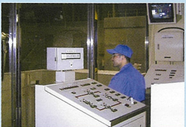
クレーン操作室…ごみクレーンを操作します。
