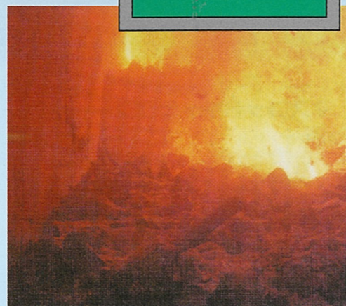
焼却炉内…約850℃～950℃の高温で焼却し悪臭は分解します。
