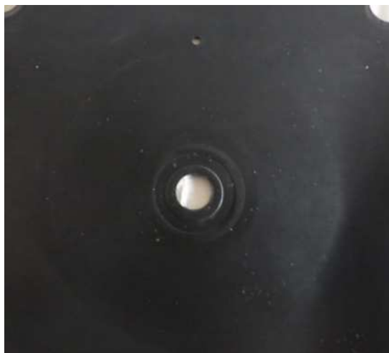
写真-5 自作ダイヤフラム(1週間運転後状態)
