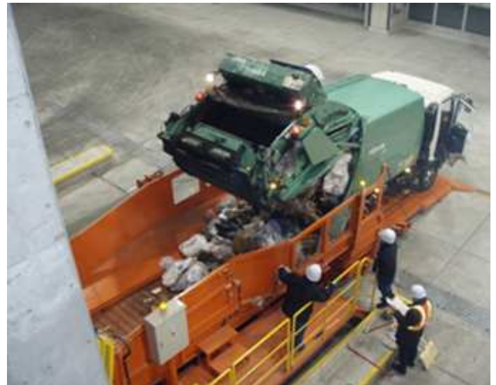
写真 - 2 搬入物検査装置を用いた搬入物検査
