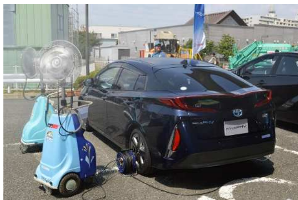
写真 - 8 PHV 外部給電の様子
