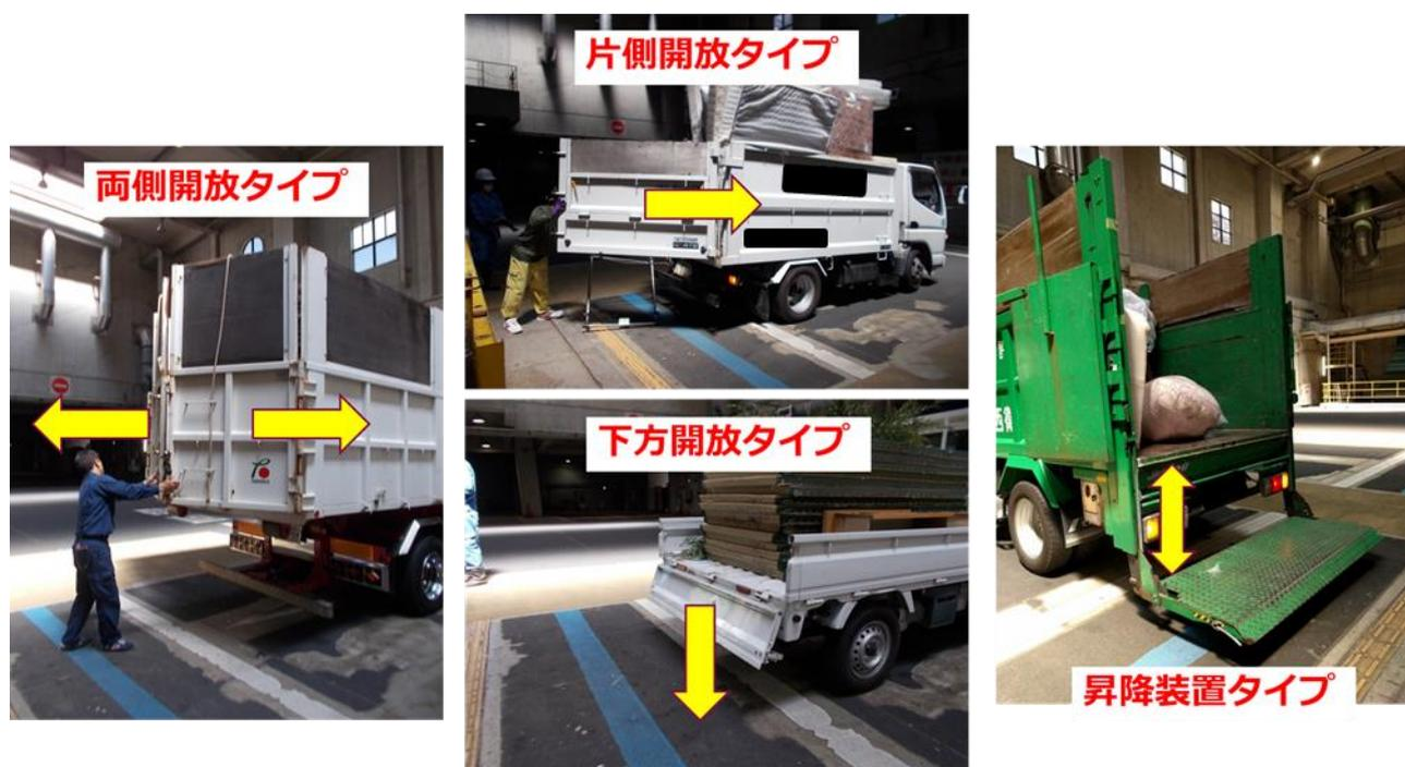
写真－2 トラック車両の後扉の構造
