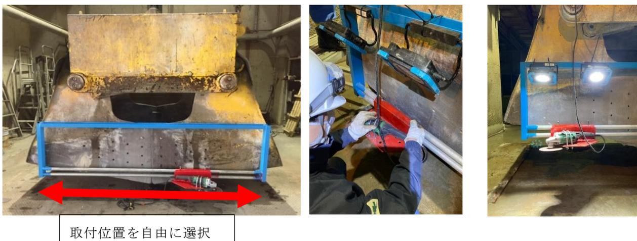
写真-3 バケットへのグラインダ取付状態(新たな改善後)
