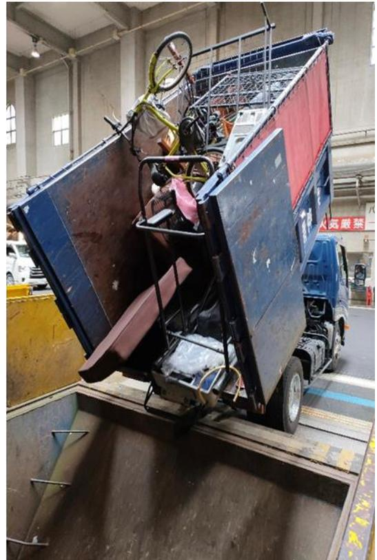
写真-3 ダンプトラックによる直接投入（直投）
