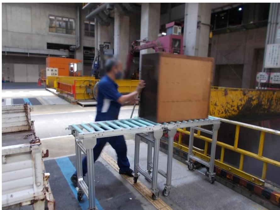
写真-15 ローラーコンベヤの使用状況
