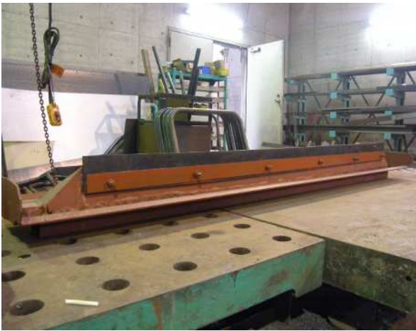
図 - 12 高刃の改造（ゴム刃取り付け）
