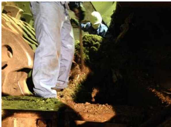
写真 - 8 回転破砕機清掃作業
