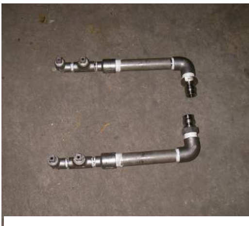
図 - 14 作成した水噴射ノズル
