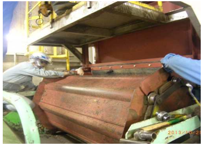
図 - 13 改造した高刃の取り付けの様子
